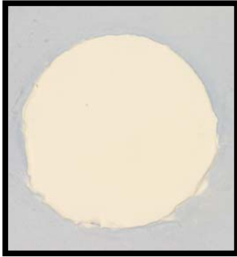
Figura 3. Muestras finales de óxido de aluminio
