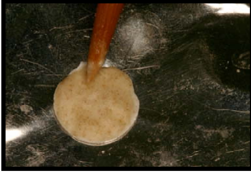
Figura 4. Aplicación del vidrio para infiltrar
